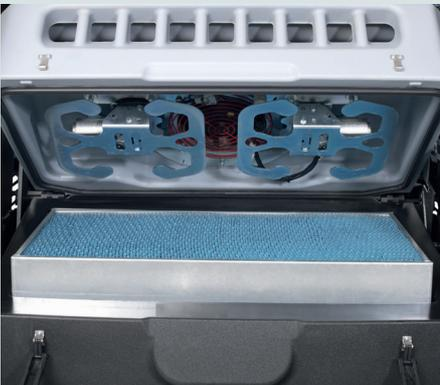
Scuotifiltro con temporizzatore multifrequenza per un'efficiente pulizia del filtro
