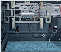
Il dispositivo elettrico di scuotimento filtro temporizzato multifrequenza pulisce il filtro scuotendolo in modo efficiente anche nelle applicazioni polverose
