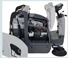
La manutenzione è facile e rapida, senza l'esigenza di strumenti per rimuovere spazzola e filtro, e grazie alla facilità di accesso a tutti i componenti
