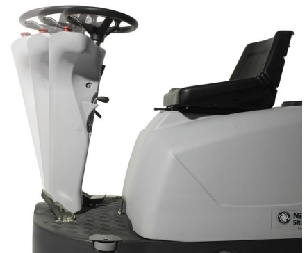
La colonna dello sterzo è regolabile così da consentire un facile accesso ed un elevato comfort all'operatore
