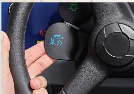
Leva SmartFlow™ intermittente integrata nello sterzo: Riduce il flusso d'acqua sulla testata spazzole, evitando gli schizzi durante le svolte, riducendo i consumi e garantendo prestazioni di asciugatura sempre impeccabili.
