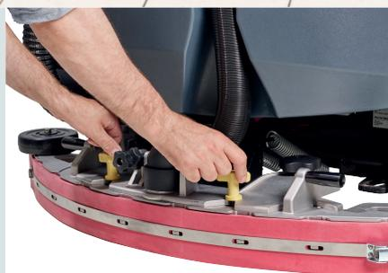
Il tergipavimento è stato progettato per essere tolto facilmente dal suo supporto usando le maniglie ergonomiche, senza necessità di scollegare il tubo di aspirazione.
