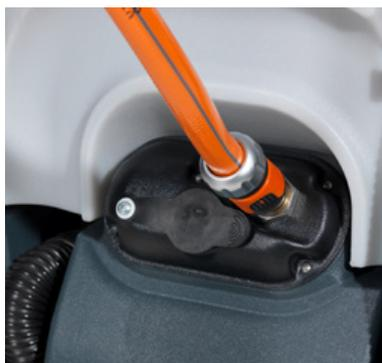
*Sistema di riempimento con arresto automatico quando il serbatoio è pieno (opzionale)*
