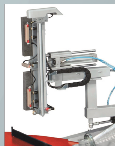
AW Sistema automatico di pinza, taglio e saldatura film Automatic clamp - cut and film welding system Sistema de pinza y corte y soldadura film
